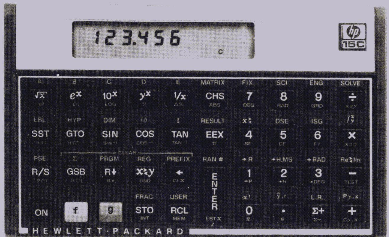
■ Chez Hewlett-Packard, le dernier né des micropoches scientifiques se range dans la lignée des 11 et 12 C, ne serait-ce que par ses caractéristiques physiques : mêmes dimensions (128 × 80 × 16 mm), même disposition de l'affichage et du clavier de 39 touches, et poids sensiblement égal (115 grammes).
