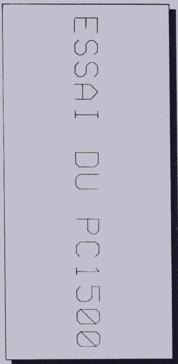
Le défilement du papier peut être commandé, en mode *texte*, par la commande LF. Celle-ci accepte des arguments négatifs qui permettent de faire reculer le papier jusqu'à 10 cm en arrière. Un inconvénient : comme il n'y a pas de détecteur de fin de papier, on arrive ainsi à le faire ressortir complètement ! Il ne reste plus alors qu'à le rengager. Il faut donc prendre ses précautions dans un programme et ne prévoir de
