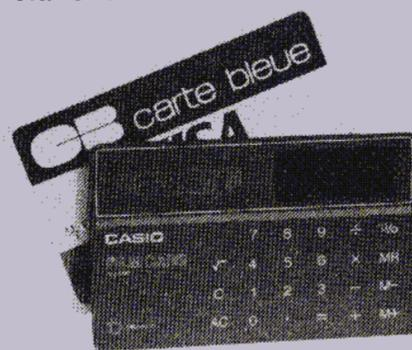
Dans un objet aussi peu épais, il était évidemment impossible de prévoir un emplacement pour une pile. L'alimentation électrique est donc assurée par quelques centimètres carrés de batteries solaires. Clavier sensitif, affichage à cristaux liquides, la calculatrice offre une surface lisse et ne comporte apparemment aucune pièce en mouvement.
