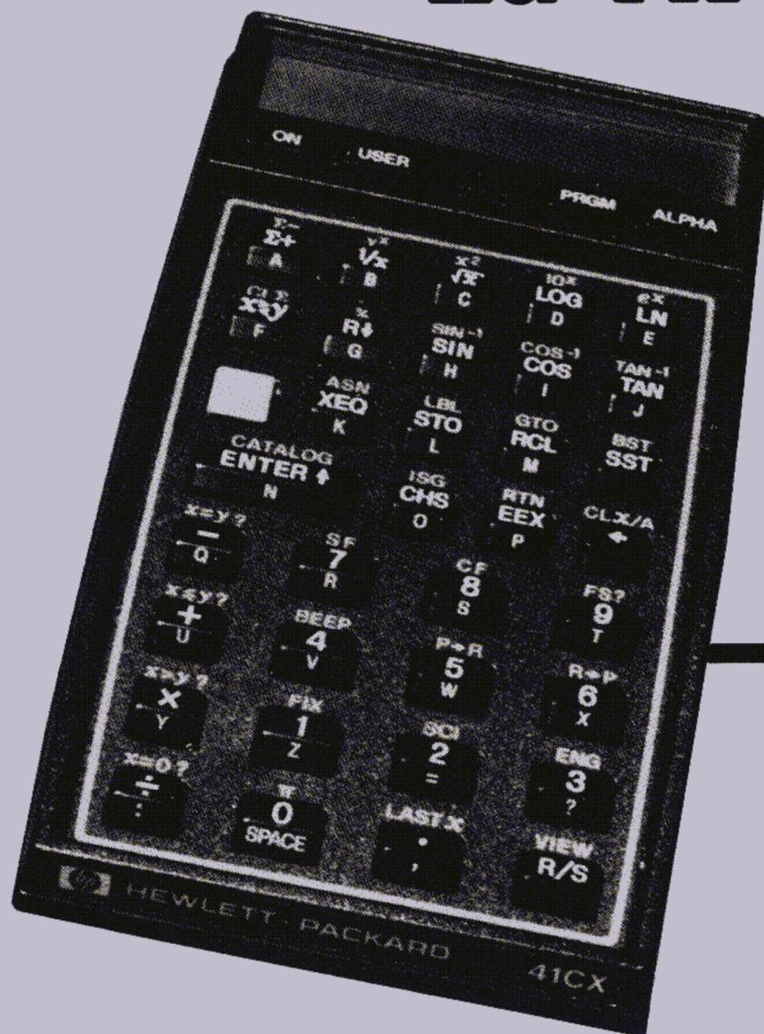
Extérieurement, la nouvelle calculatrice de Hewlett-Packard ressemble beaucoup aux 41 C et CV : mêmes dimensions et même aspect. Mais le boîtier renferme les modules X-Fonctions et Horloge, 3 122 octets de mémoire vive et 19 nouvelles fonctions. La machine est en vente à un prix voisin de 3 000 FF ttc.
