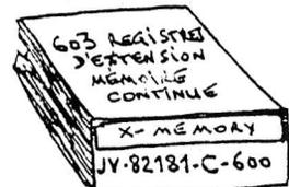
CE MODULE EST D'ENCOMBREMENT IDENTIQUE À UN MODULE STANDARD. - LA "41 CX 1652" EST LIVÉE AVEC 2 MODULES. - GRÂCE À LA MÉMOIRE CONTINUE (ENVIRON 6/48 HEURES, MAINTIEN-TYPE: 24 HEURES), LES MODULES PEUVENT ÊTRE RETIRÉS MOMENTANÉMENT, OU PLACÉS DANS UN PORT-MODULE EXTERNE (MAINTIEN INDEFINI: PLUSIEURS MOIS)
